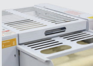
Proteção móvel intertravada com parada imediata
