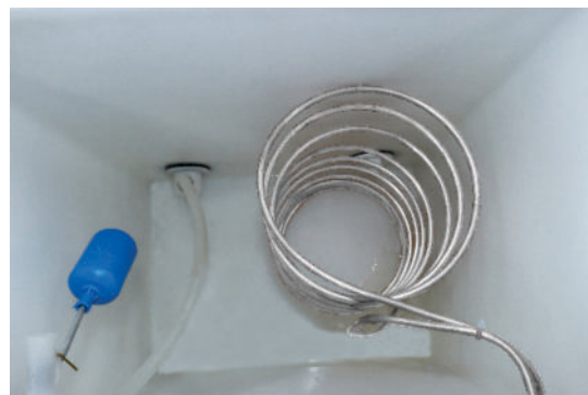
(Fig. 1) Vista do reservatório para água com a serpentina e a bóia.
