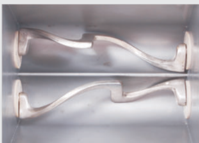
Batedores em ferro fundido nodular (estanhado)
