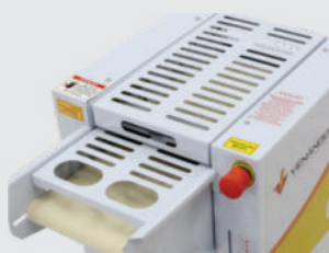
Proteção móvel intertravada com parada imediata
