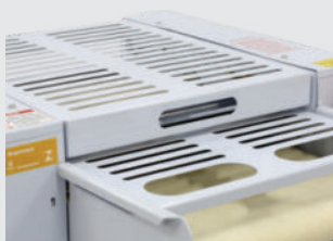
Proteção móvel intertravada com parada imediata
