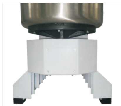
Túnel para facilitar a limpeza
